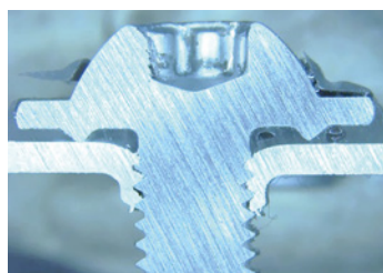
Schliffbild einer Direktverschraubung Microsection of screw in extrusion-embossed hole
